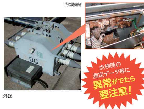
錆による密閉部の腐食 (腐食で気密性がなくなった)
