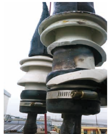
漏れ電流により焼損した高圧ケーブル
