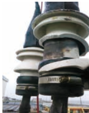
漏れ電流により焼損した高圧ケーブル
