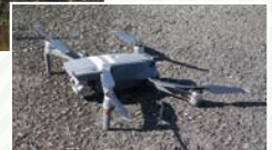
エリア設置図面に合わせた自動航行プログラムによる撮影(空撮時間:15分程度/1エリア)
