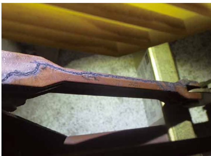
事故点:トランス気中負荷開閉器(LBS) トラッキング状況
