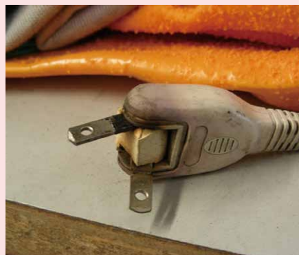
過熱により変形した可動プラグ
