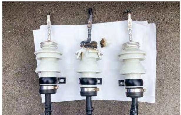
施工不完全により過熱・焼損した高圧ケーブル端末
