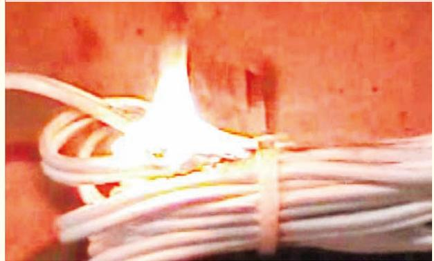
延長コードを束ね放熱されにくい状態で、たくさんの電気機器を使用すると、保護材が溶け出し、導体がむき出しになることで、ショートが発生
