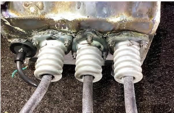
雷害により焼損した高圧負荷開閉器
