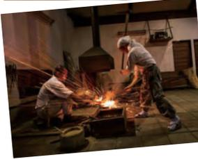
月に1度、1,200度の高熱で玉鋼を打ち延ばす「古式鍛錬」の見学も可能で、海外の日本刀ファンも押し寄せるほど人気になっています。職人が力強く鋼を打ち、火花が飛び散る様子は迫力満点!「相槌を打つ」という言葉の語源となった作業です。
